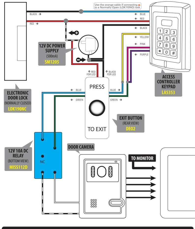
CONNECTING AN ACCESS CONTROL SYSTEM TO THE DOSS VIDEO DOOR PHONES USING A RELAY
