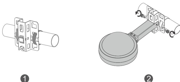
拿出兩個扣環，按照示意圖將金屬支架固定在橫柱上
