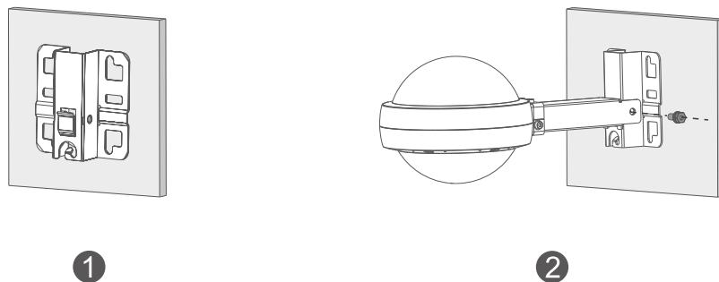
1. Asegure la placa de montaje en la pared con pernos de expansión.
