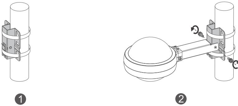
1. Kencangkan plat pemasangan pada tiang vertikal dengan menghubungkan dua klem melalui plat pemasangan.
