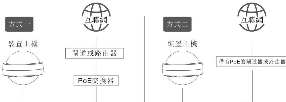
備註：裝置亦支援 DC12V,  $\geq 2A$  電源變壓器，變壓器需自行購買。
