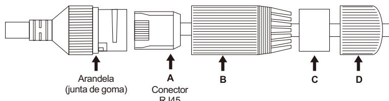
3. Instale un conector RJ45 en el extremo sin terminación del cable Ethernet utilizando una herramienta de instalación para cables Ethernet.
