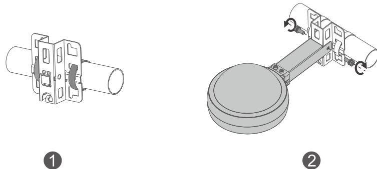
Fixez le support de montage au poteau horizontal en enfilant deux colliers de serrage à travers le support de montage.
