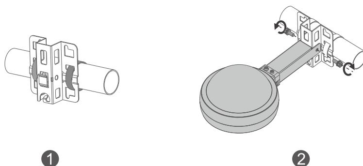
1. Asegure la placa de montaje a la barra horizontal enroscando dos abrazaderas a través de la placa de montaje.
