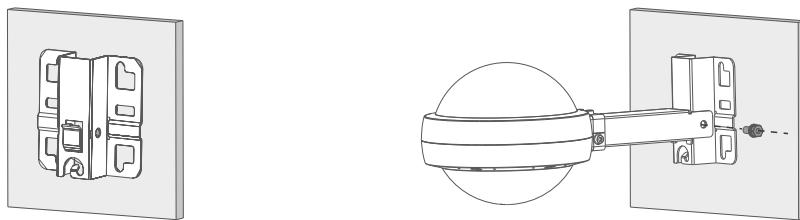
1. Kencangkan plat pemasangan pada dinding menggunakan baut ekspansi.
