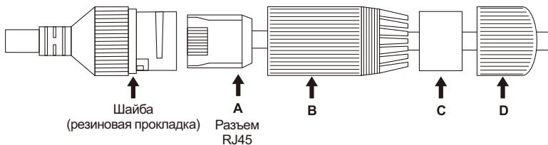
3. Установите разъем RJ45 на открытый конец кабеля Ethernet с помощью кабельного инструмента.
