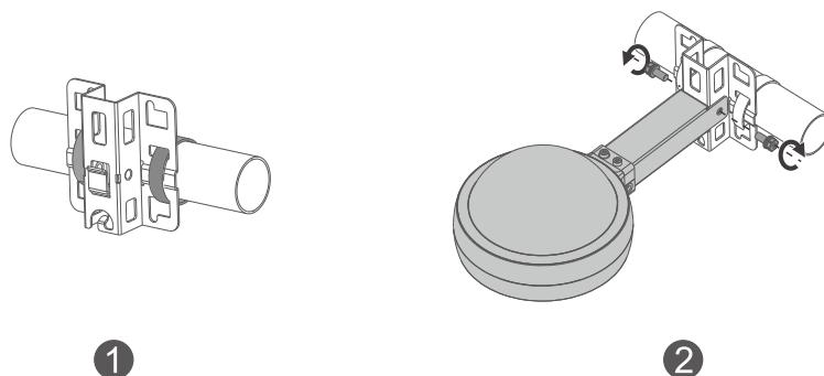
1. Закрепите монтажный кронштейн на горизонтальной трубе с помощью пластиковых хомутов, продев их в соответствующие отверстия кронштейна.
