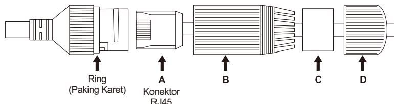
3. Pasang konektor RJ45 di ujung kabel Ethernet yang belum diterminasi menggunakan alat crimping.
