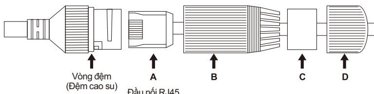
3. Lắp đầu nối RJ45 vào đầu chưa nối của cáp Ethernet bằng công cụ lắp đặt cáp Ethernet.
