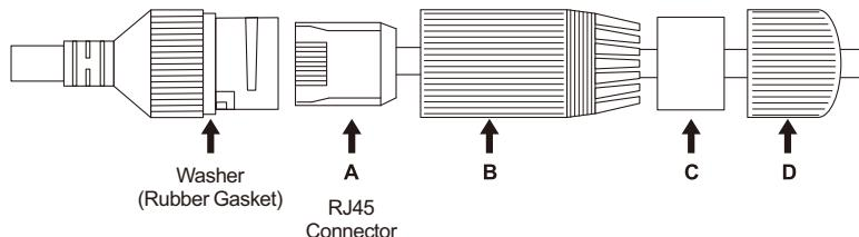
(3) Nachdem das Kabel durch den wasserdichten Stecker geführt wurde, bearbeiten Sie den RJ45.
