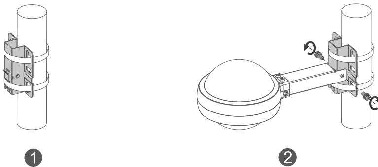
1. Asegure la placa de montaje a la barra vertical enroscando dos abrazaderas a través de la placa de montaje.
