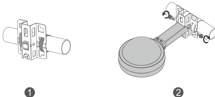
1. Kencangkan plat pemasangan pada tiang horizontal dengan menghubungkan dua klem melalui plat pemasangan.
