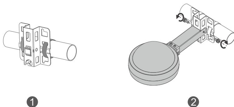
Befestigen Sie die Montagehalterung am horizontalen Mast, indem Sie zwei Klemmen durch die Montagehalterung schrauben.
